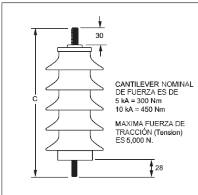
Figure 6. Pararrayo envolvente UltraSIL sin desconectador, para base o montaje de cable superior (pararrayo puede estar horizontal o vertical con cualquier extremos a la línea).
